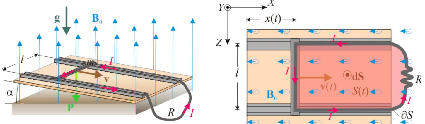
Adoptamos un sistema de referencia cartesiano cuyo eje  $X$  es paralelo a las guías, y con el eje  $Y$  perpendicular al plano inclinado que las soporta. La varilla móvil se mantendrá siempre paralela al eje  $X$ , y su desplazamiento estará descrito por una vector velocidad  $\mathbf{v}(t) = v(t) \mathbf{i}$ .
